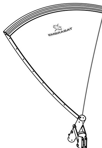
7 - Iniciar a montagem pela Pétala com a logomarca EMBRASAT, no lado superior do Canhão. Isto fará com que a logomarca fique na parte superior da antena após montada.
