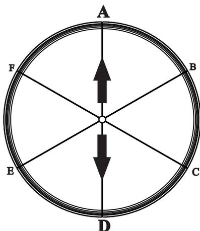
14 - Após a montagem de todas as Pétalas, fazer aperto final da união das Pétalas. Iniciar do centro da antena para a extremidade e de forma simétrica. Apertar todos os parafusos referentes a união "A", em seguida a união "D".
