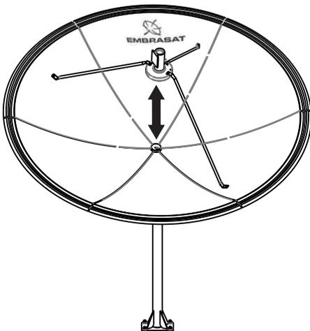
20 - Verificar se a Distância Focal, do centro da antena até o centro do *Disco Escalar*, está conforme a folha de ESPECIFICAÇÕES TÉCNICAS.
