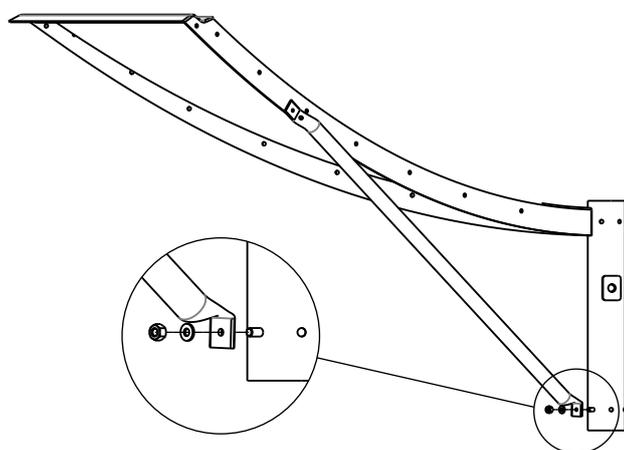
10 - Parafusar a extremidade inclinada da longarina na parte inferior do canhão.
