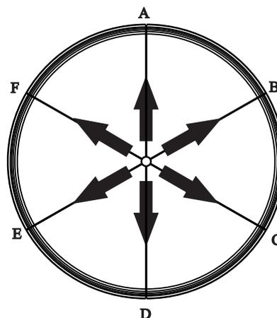
17 - Fazer o aperto final das Longarinas, seguir a mesma sequência anterior, iniciar do centro da antena para a extremidade e de forma simétrica. Sequência: "A"- "D", "B"- "E", "C"- "F".
