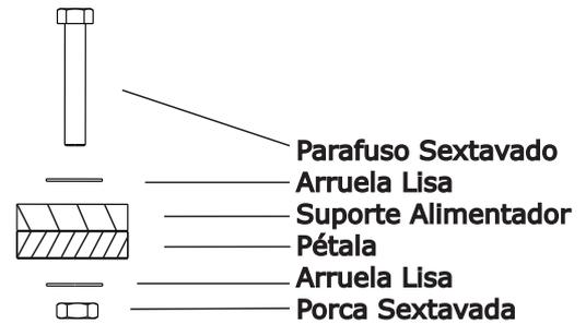
18- Pré montar os Suportes do Alimentador nas Pétalas e no *Disco Escalar* (item não incluso). Após a pré montagem fazer o aperto final dos parafusos de fixação. VER UNIÃO PARAFUSADA.
