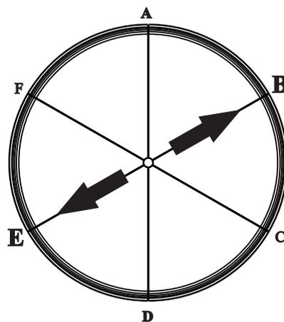
15 - A próxima união a ser apertada é a "B", em seguida a união, oposta, "E". Sempre iniciar o aperto final da união do centro da antena para a extremidade.
