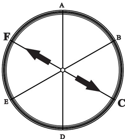
16 - Na sequência, a união a ser apertada é a "C", em seguida a união, oposta, "F". Sempre iniciar o aperto final da união do centro da antena para a extremidade.
