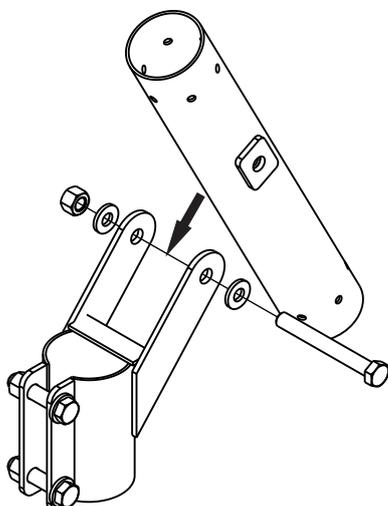
**4 - Alinhar o Canhão perpendicularmente ao Acoplador e fixar os parafusos. Após a fixação, rebater o Canhão na posição horizontal e fixar o parafuso no Esticador.**
