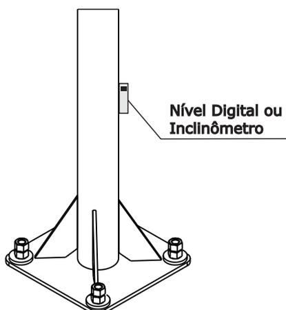
**2 - Com o Mastro fixado, verificar a verticalidade utilizando o nível digital ou o inclinômetro. Caso seja necessário fazer alguma correção, utilizar calços metálicos entre a base de concreto e a base do Mastro.**
