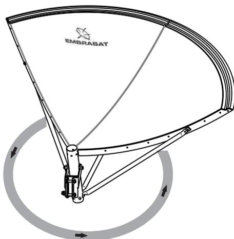
12 - Fazer a montagem da segunda Pétala (observar a direção de montagem). Repetir os passos anteriores para a montagem e fixação da Pétala e das Longarinas.
