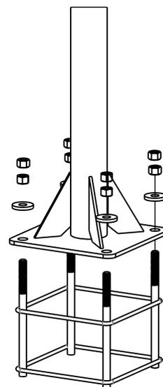
**1 - Parafuse a sapata da base com parafuso 1/2", transpassando a laje (PRÉDIO), ou com chumbadores em bloco de concreto (Solo).**
