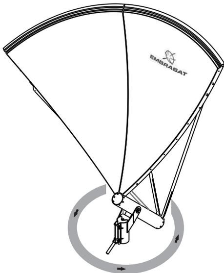
12 - Fazer a montagem da segunda Pétala (observar a direção de montagem). Repetir os passos anteriores para a montagem e fixação da Pétala e das Longarinas.
